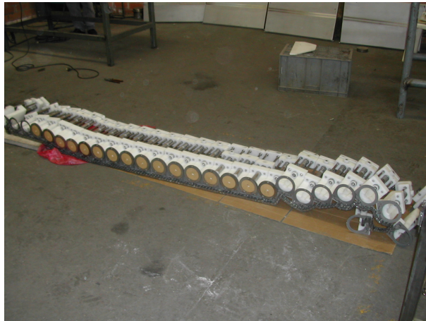
Figura 7.29: Agarre de los módulos a las cadenas
