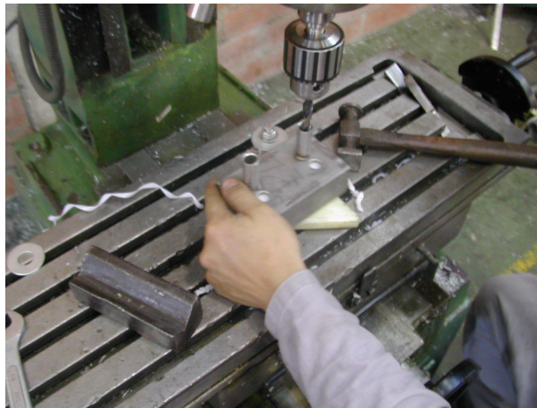
Figura 7.22: Operación de perforado
