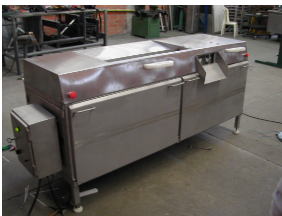
Figura 7.10: Guardas terminadas y montadas en la estructura
