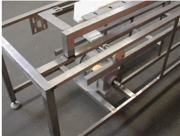
Figura 7.6: Soporte del motor
