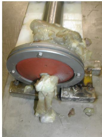
Figura 4.4: Resultado en la operación de fileteado horizontal, notese la salida del hueso pelado por la parte frontal
