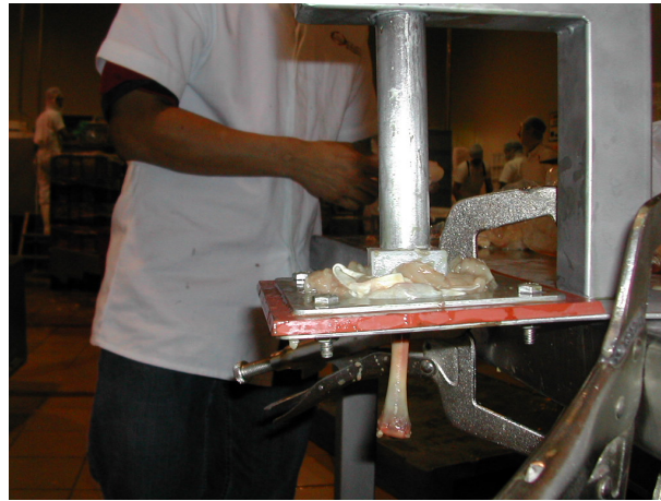
Figura 4.2: Resultado en la operación de fileteado vertical, Notese, en la parte inferior salida del hueso pelado
