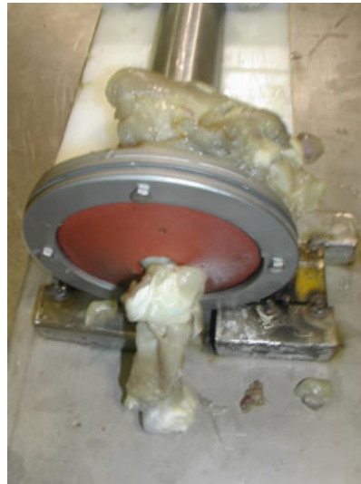
Figura 6.2: Resultado de la operación con cilindro neumático, notese la salida del hueso pelado por la parte frontal
