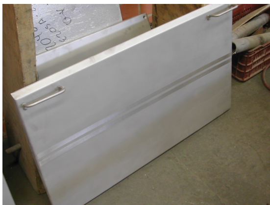
Figura 7.9: Guarda frontal acabado en sandblasting
