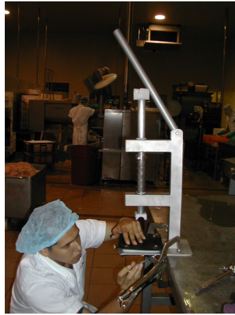
Figura 4.1: Operación experimental de fileteado vertical
