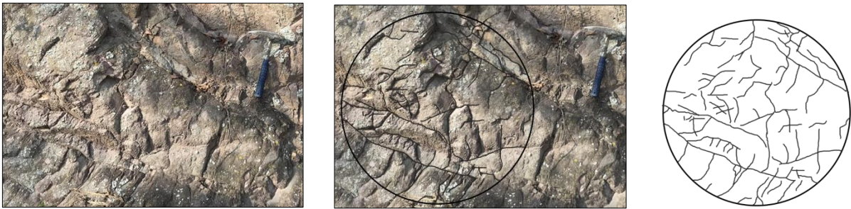
Figura 80. Digitalización de las fracturas en los afloramientos utilizando la ventana de muestreo circular. El ejemplo pertenece a la estación de campo LB26.
