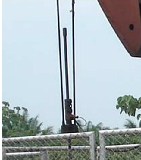
Figura 7. Típica instalación de una celda dinamométrica
