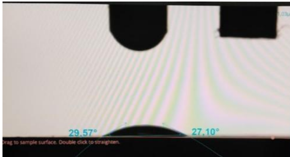
Figura 2. Medición del ángulo de contacto mediante el equipo Theta Attension optical tensiometer (KSV Instruments).
