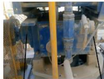
Fig.2 Reductor separador dinámico
