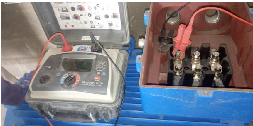
Figura.49 Esquemático medida de aislamiento motor eléctrico.
