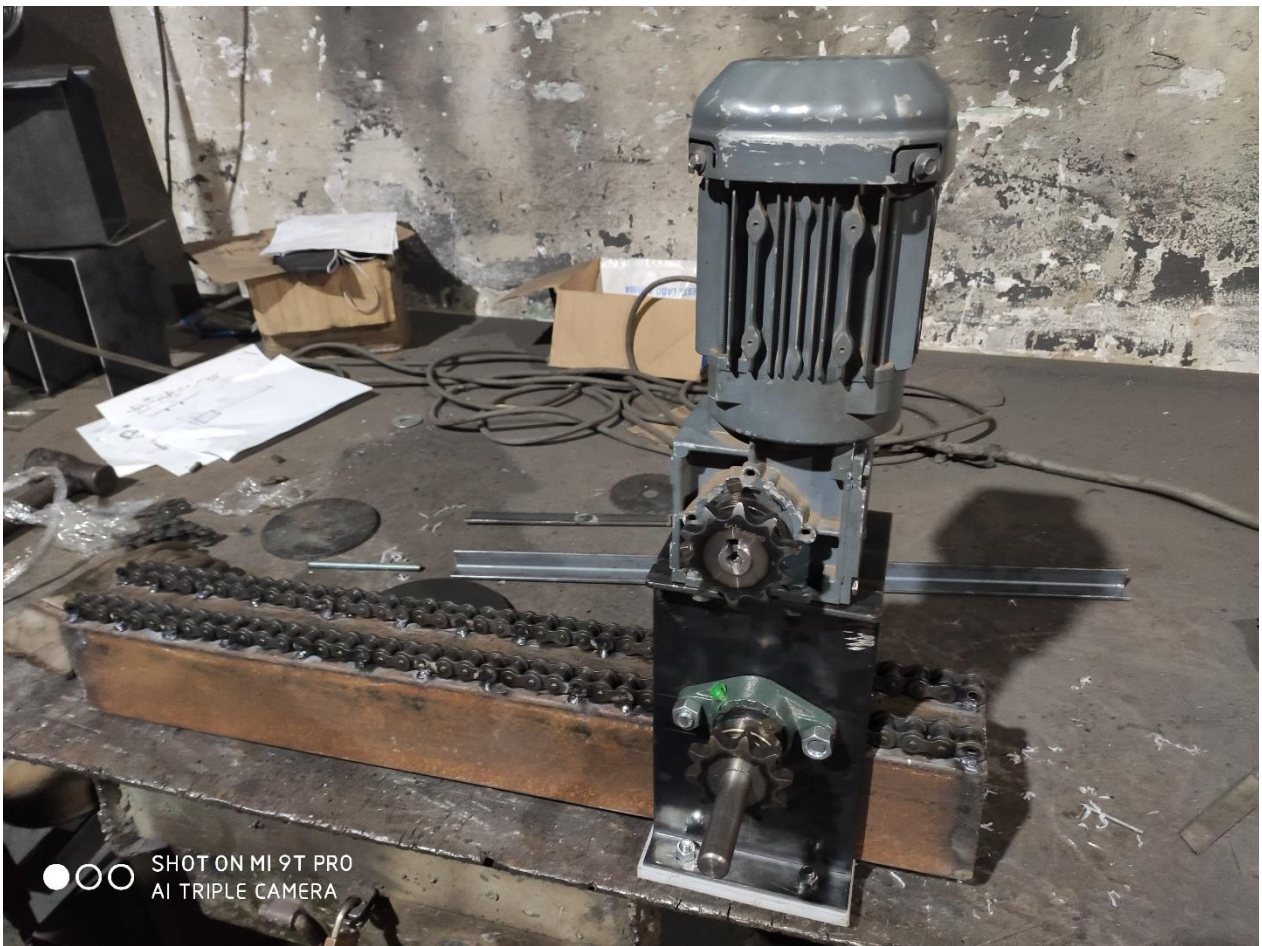
Figura 49. Ensamble de Viga puente con carro de portaherramientas.
