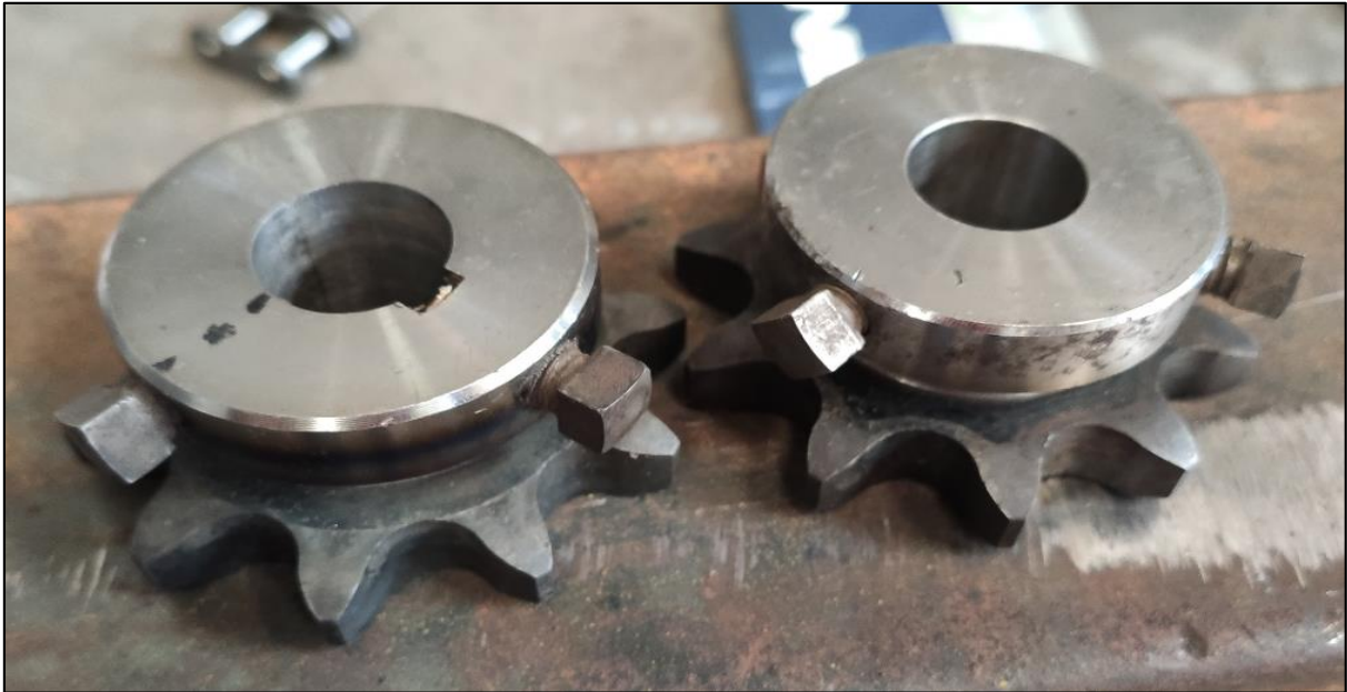
Figura 48. Sprockets usados en el sistema de desplazamiento 60B10.
