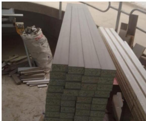
Se cortan cabezales de closet y se instala riel superior. En este punto ya hay un avance de fabricación del 70%, a continuación, en la figura 13, se presenta un cabezal de closet con riel ya instalado.
