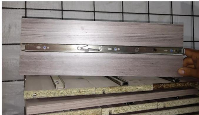
Se acanalan los testeros y costados de las gavetas, que corresponden a un avance del 2% de fabricación y acumulado del 6%, a continuación, se presenta en la figura los testeros y costados de gavetas ya acanalados en la figura 6.
