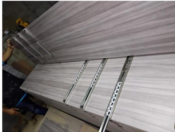
La instalación de rieles en el costado interior y deslizadores, para un avance de fabricación del 4% y un porcentaje del 14% acumulado, a continuación, en la figura 8 se muestra el costado interior con rieles ya instalados.
