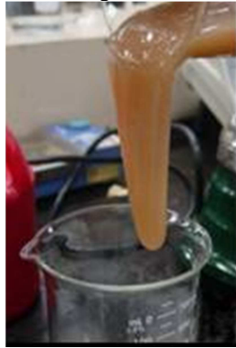
Figura 44. Formación de la lengua del fluido base aceite vivo.
