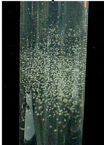
Figura 45. Resultado de mojabilidad visual en fase agua.
