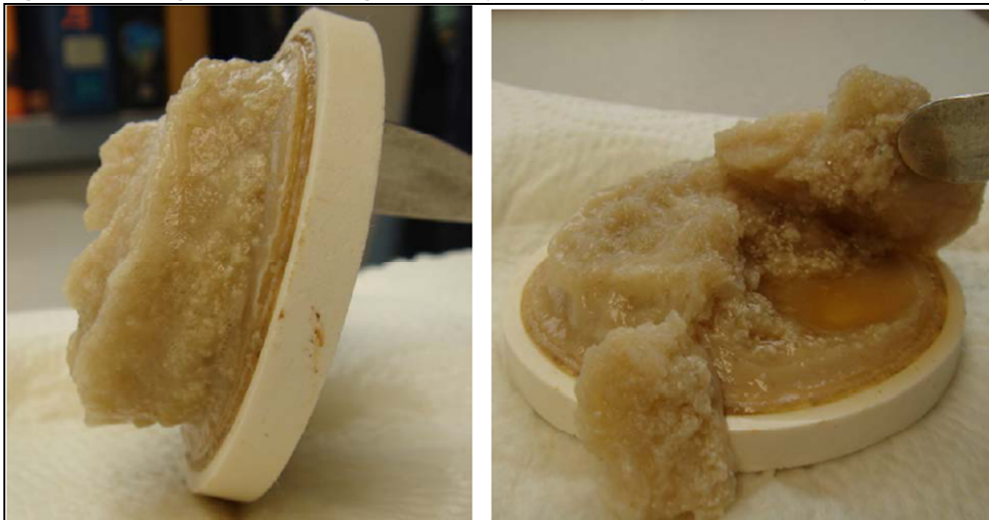
Figura 49. Imagen de residuos generados por un fluido polimerico al Pazar por un filtro de 300 mD.
