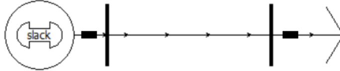
Figura 8. Esquema circuital para calcular P_e
