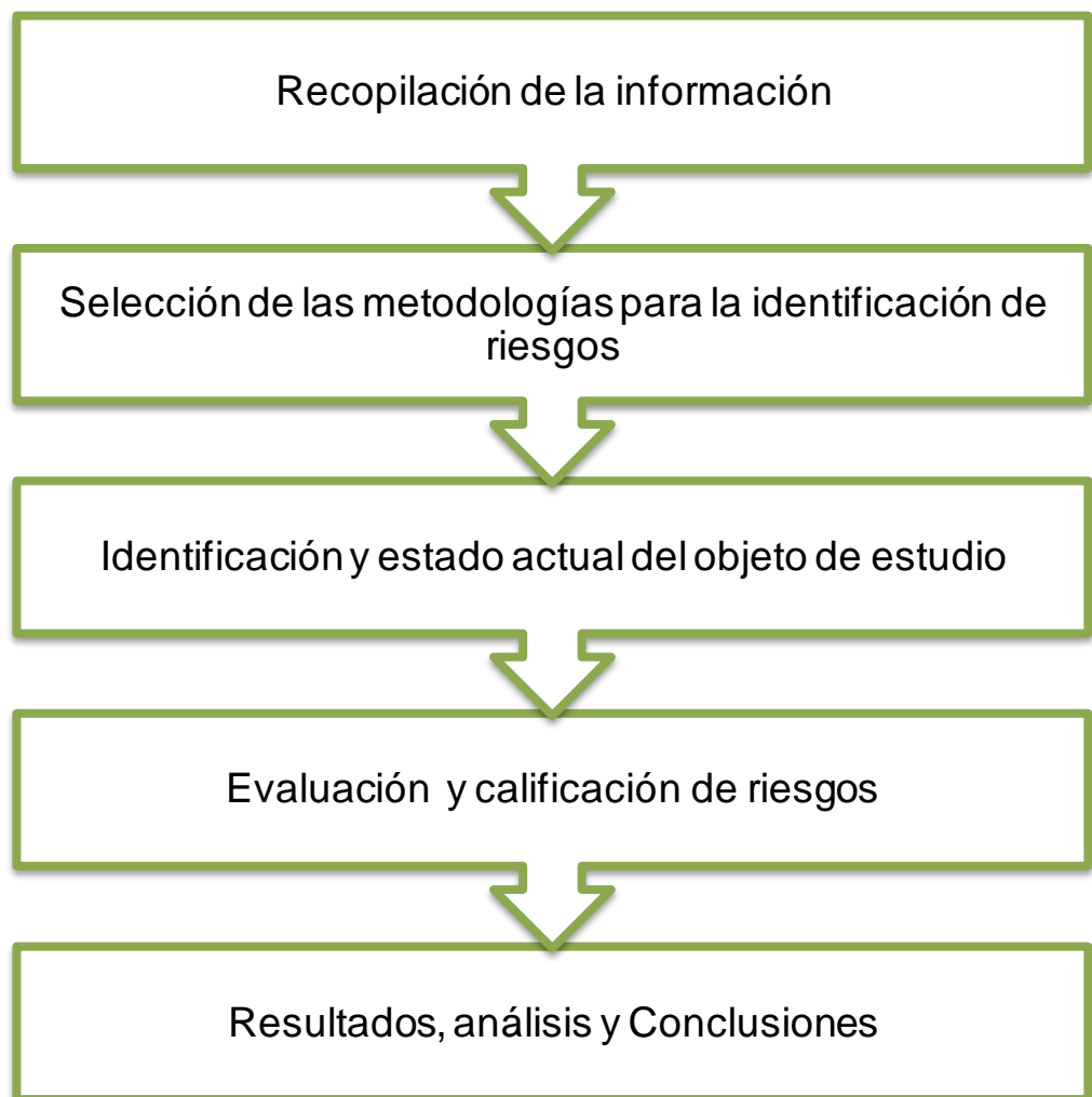
Figura 1 - Diagrama del proceso de PHA
