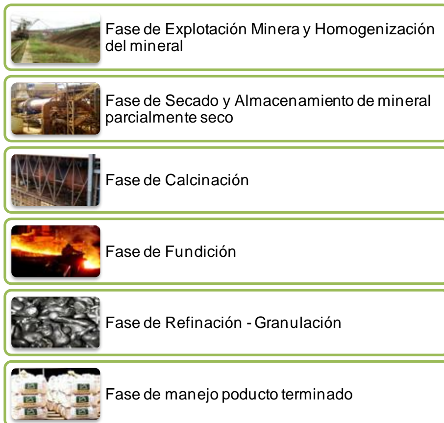
Figura 2 - Fases que componen la producción de Ferroníquel
