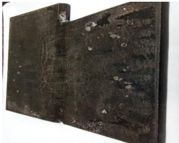
Figura 9. Soldadura de Acero al Carbono.
