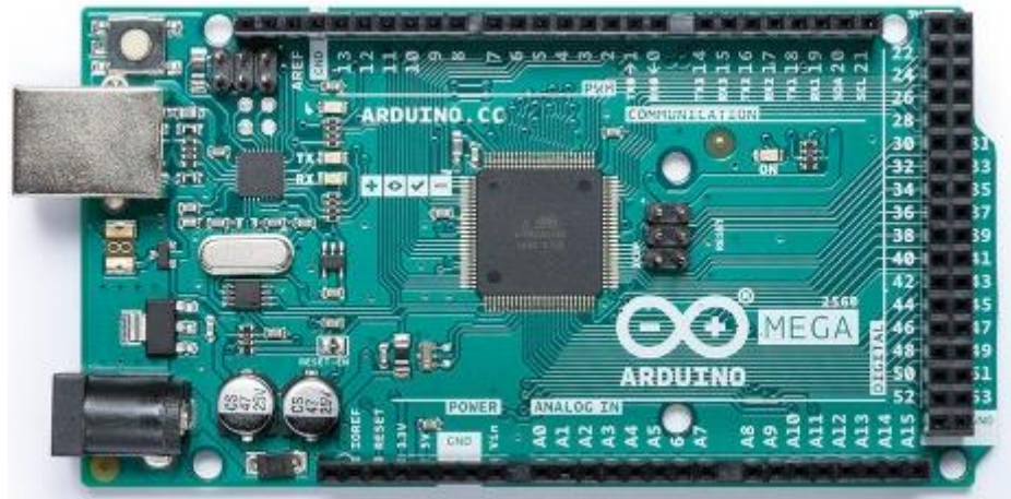
Figura 17. Arduino MEGA empleado. Tomado de LA RED ELECTRONICA S.A.S.
