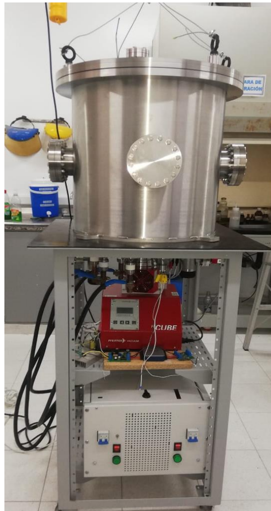
Figura 26. Sistema de evaporación multietapa. Fuente Autores.
