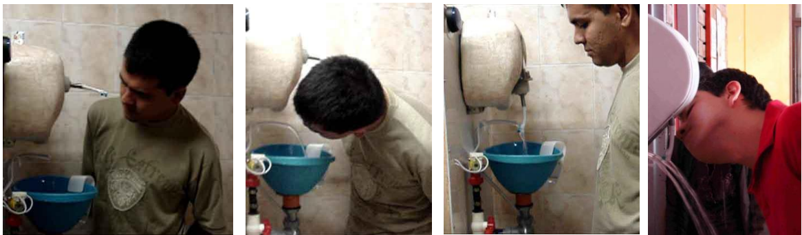
Figura 151. Enjuague y lavado. El accionamiento para el enjuague se realizaba por la palanca blanca sujeta a la poceta. Cuando el usuario apagaba el sistema, el cepillo se recogía para ser lavado en la misma trayectoria de agua. 197
