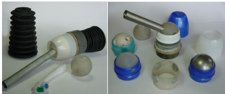
Figura 123. Alternativas de solución construidas para garantizar libertad de movimiento. Los imanes fueron descartados definitivamente, pues su potencia para sujetar implicaba robustez en el imán; el caucho fue descartado por motivos similares 163
