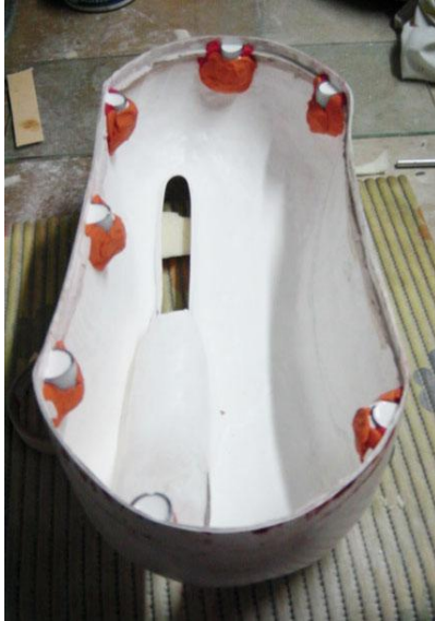
Figura 187. Carcasa con adiciones posteriores al moldeo. 236
