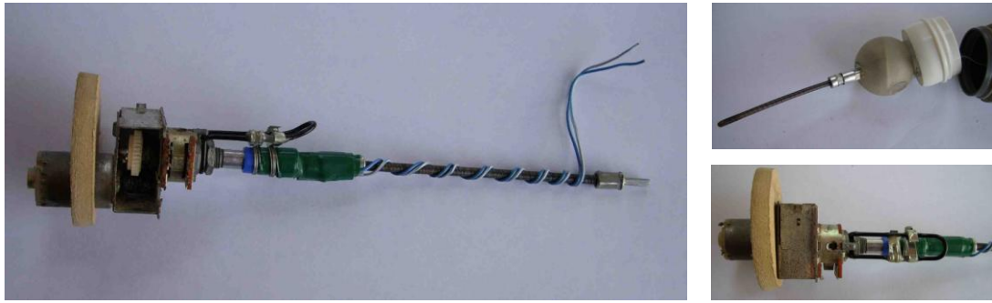
Figura 124. Propuesta para el giro mecánico. Este modelo presenta cerca al eje del motor, unos terminales metálicos a modo de escobillas; el propósito era el de que pudiera girar sin que por ello los cables se enredaran. 164
