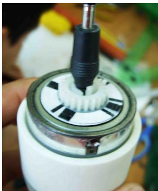
Figura 139. Encoder. “5” y “2” representan el espesor de la franja en mm. Se hicieron de 5 a 2 mm y se probaron para determinar la precisión del giro. Se escogió el de 2 mm. Para mayor información sobre los componentes estándar ver Anexo 9. 181
