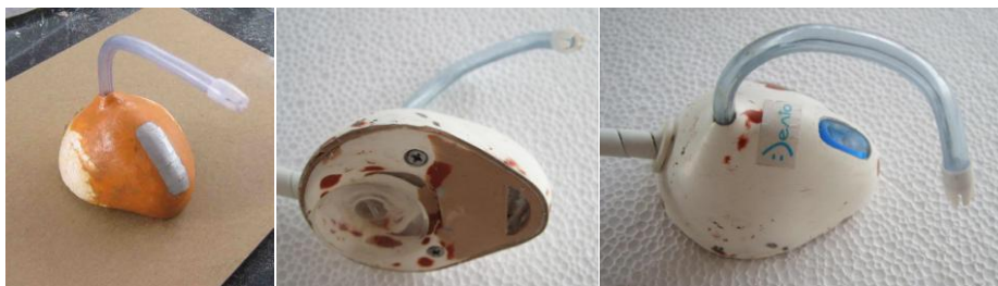
Figura 155. Elemento para el enjuague. Esta pequeña carcasa ensamblada contiene al sensor de proximidad y a una boquilla de salida para agua. En la tapa inferior, posee una ventosa para acoplar a una superficie lisa como las del lavamanos, un dispositivo acoplable para atornillar, y una salida para el agua, debido a un pequeño orificio que funciona como desahogo para la presión, ofreciendo una trayectoria de agua suave. 201
