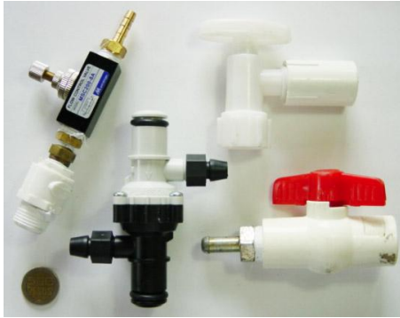
Figura 150. Válvulas de paso. 196
