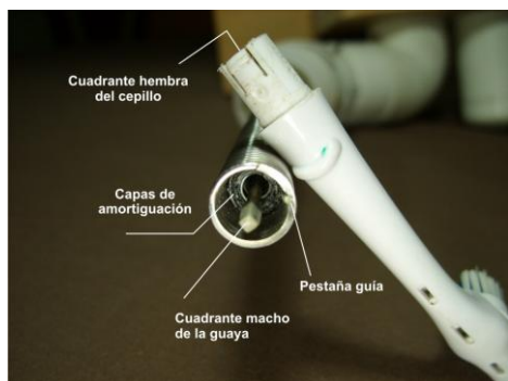
Figura 130. Detalle del acoplamiento del cabezal del cepillo. 170
