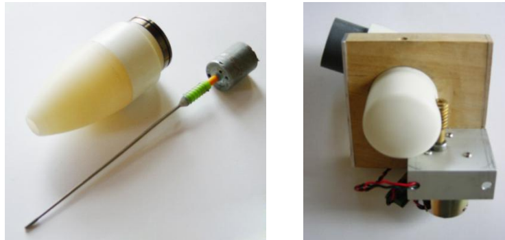
Figura 138. Elementos corregidos del subsistema. Los ajustes de los rodamientos fueron más exactos con las piezas torneadas en Duralón. 180
