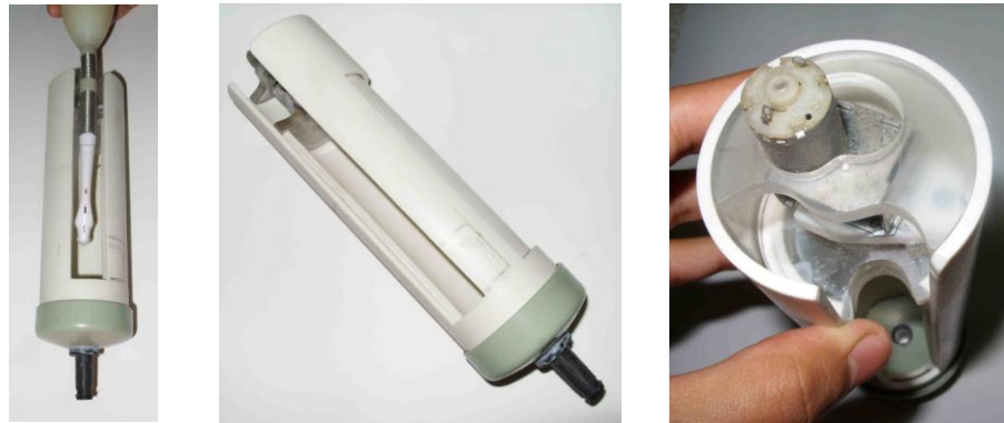
Figura 153. Cámara de lavado construida. La cortina es un elemento que requirió de una gran labor para lograr precisión en el movimiento. Como el motor es fijo, se necesitaba de una ranura en la parte superior para impedir obstaculizar el recorrido. 199
