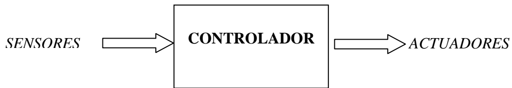
Figura 180. Esquema de funcionamiento básico. Los sensores transmiten información al controlador, y este tiene preestablecida la orden que le dará al actuador. 229
