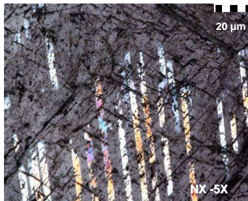
Figura 31. Microfotografía de un cristal romboédrico de dolomita con macla polisintética laminar. Muestra LME016009
