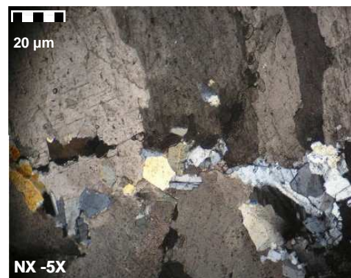
Figura 30. Microfotografía de una fractura rellena de albita (con macla polisintética) y cuarzo (con extinción ondulante) que corta la dolomita romboédrica. Muestra LME016008.
