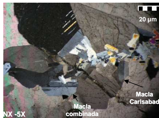
Figura 33. Microfotografía de la dolomita cortada por una fractura rellena de albita maclada. Muestra LME016013 (1).
