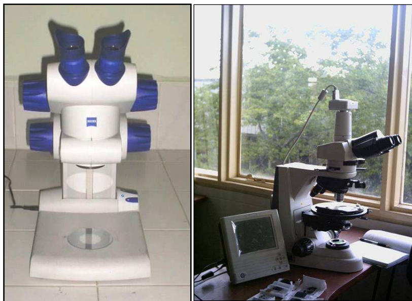
Figura 1.(a) Lupa Estereoscópica Carl Zeiss Jena; (b) Microscopio de Luz Transmitida Nikon Elipse 50i
