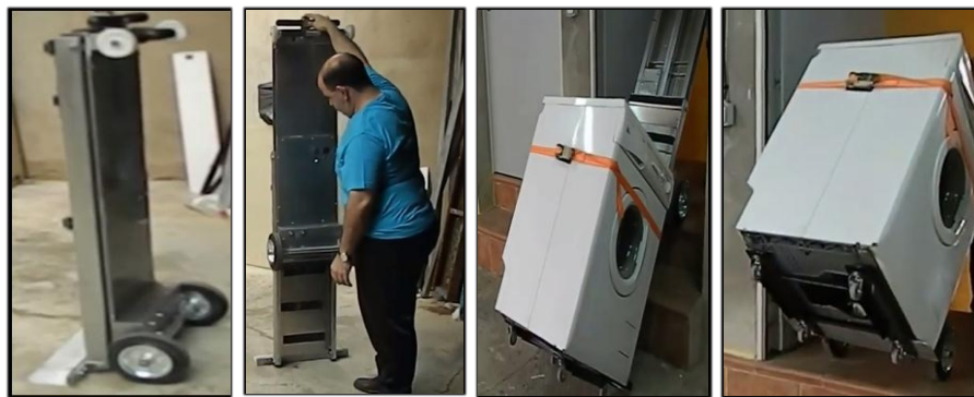
Figura 4. Características físicas de la carretilla eléctrica sube escaleras
