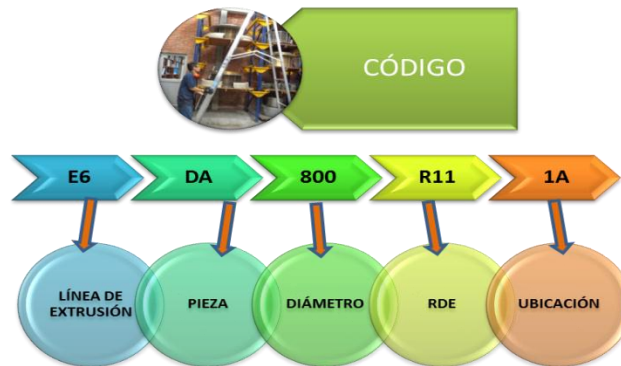
Ilustración 8. Convenciones del código de la pieza
