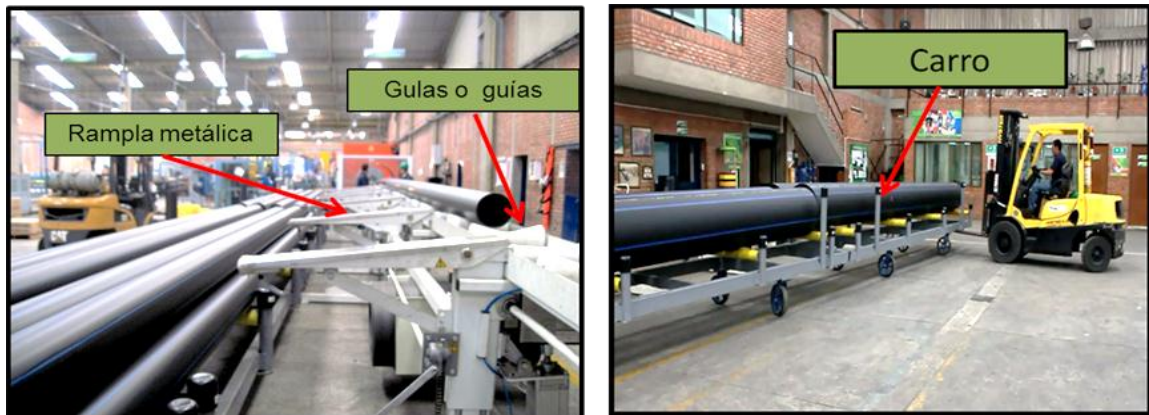
Imagen 21. Zona de almacenamiento temporal línea E6
