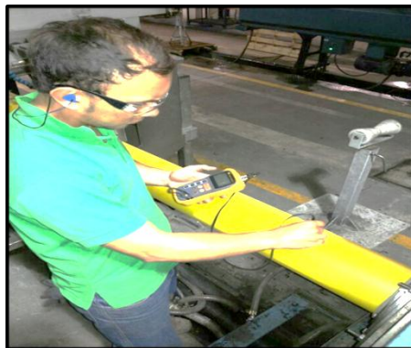
Imagen 12. Medición de espesor (ultrasonido manual)
