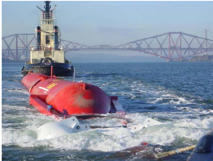
Figura 75. Transporte del pelamis a su ubicación final.
