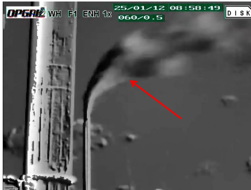
Imagen 18. Detección de la emisión fugitiva en el proceso de regeneración, captado por la cámara de detección óptica – infrarroja
