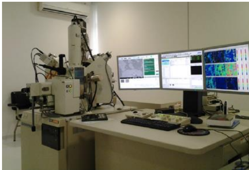
Figura 4. Microsonda electrónica, Departamento de Geociencias de la Universidad Nacional de Colombia sede Bogotá. Tomado de Jimenez (2016).
