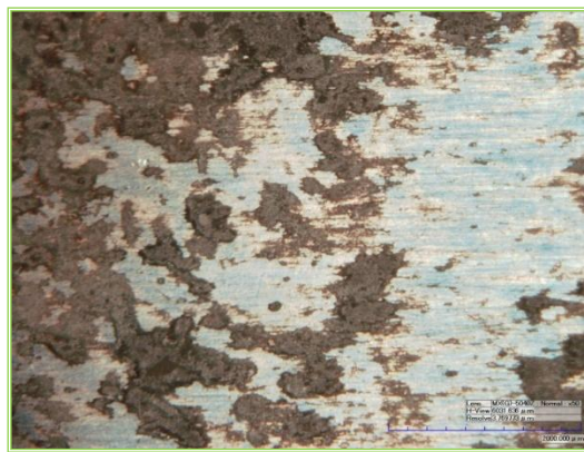
Fotografía 4. Probeta oxidada isotérmicamente a 600°C-168 horas a 50x
