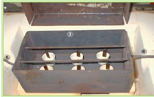
Figura 6. Reactor metálico con la distribución de las probetas
