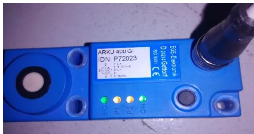
Figura 4. Sensor ultrasónico para medida de nivel
