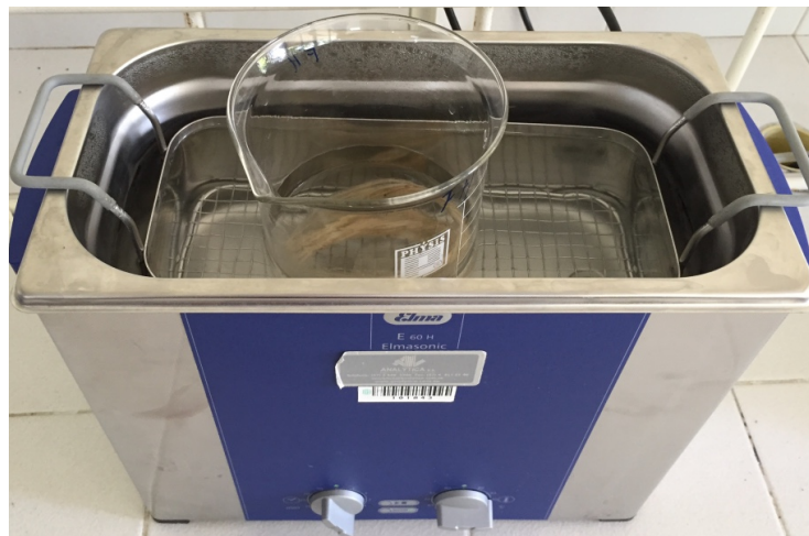
Figura 6. Limpieza de las fibras vegetales de fique y yute.
