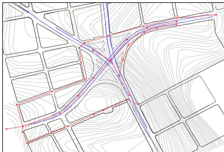
Ilustración 9 Trazado de los colectores en AutoCAD Civil 3D.
