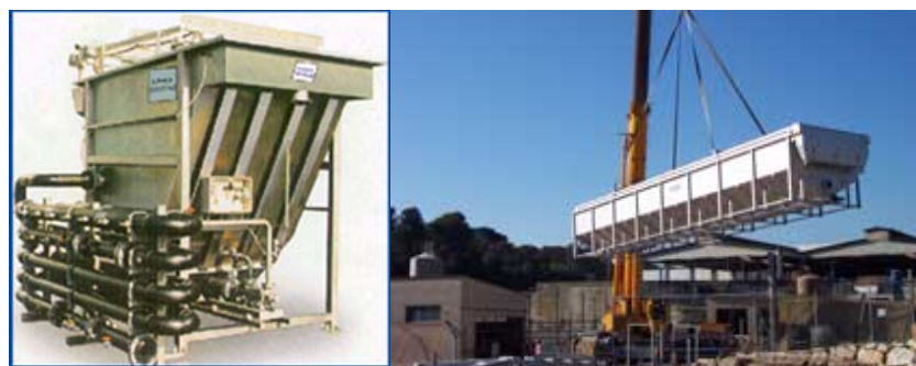
Figura 34. Unidades de flotación tipo gas disuelto
