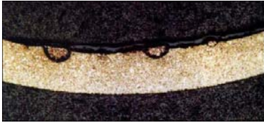
Fig. 9 Presencia de dezincificación tipo tapón, en el diámetro interno de un tubo de admiralty de un condensador.
