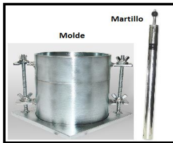
Figura 16. Equipo utilizado para llevar a cabo el ensayo de Proctor modificado. Adaptada de RICELI EQUIPOS y AMERICAN CUBE MOLD.
