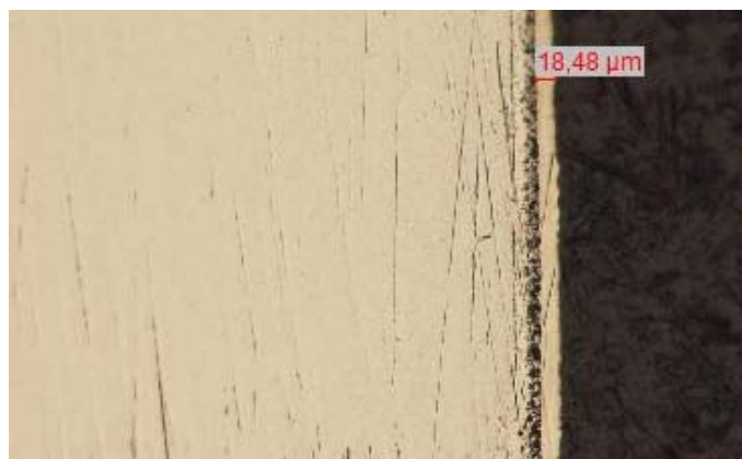
Figura D. Espesor de recubrimiento electroquímico de Níquel.
