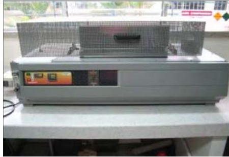
Figura 7. Montaje de probeta-soporte para la oxidación.
