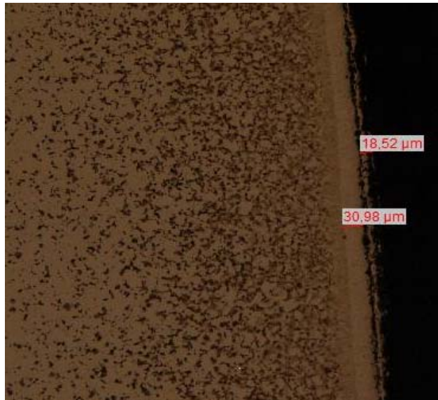
Figura A. Cementación empacada en 2 horas a 800°C + 3 horas a 1000°C. 10x.
