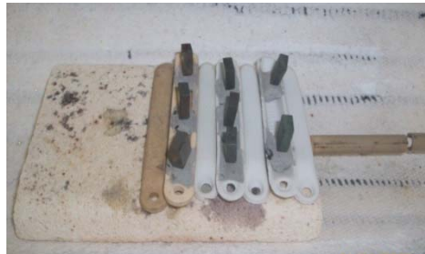
Figura 7. Montaje de probeta-soporte para la oxidación.
