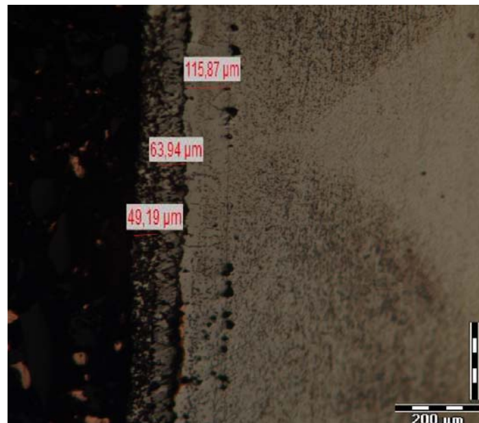
Figura 15. Acero T91 modificado con barrera Cr-Si expuesto a 800°C durante 455 horas.
