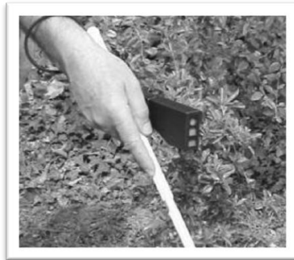
Ilustración 10. Teletact (Laboratorio LAC)
