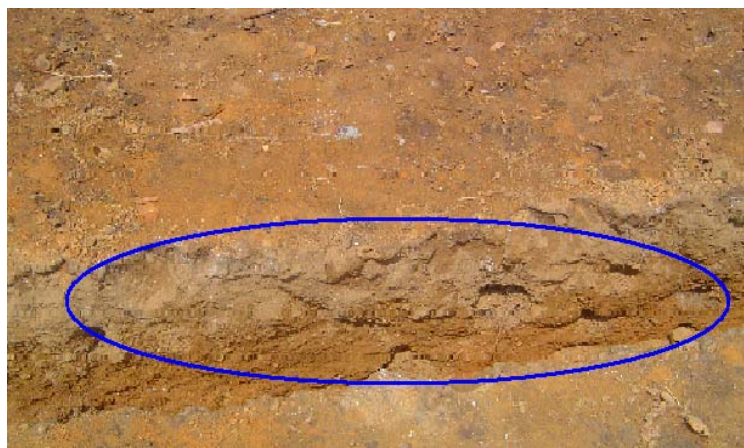
Fotografía 22: Hormigueros que se presentan en el suelo de fundación
