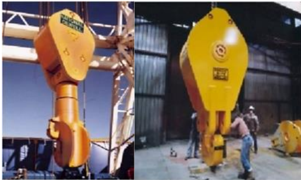
Figura 61. Izquierda: Bloque viajero. Derecha: Gancho
