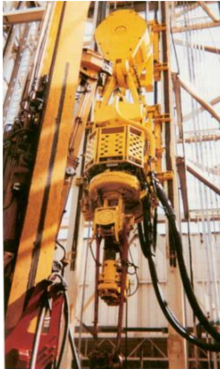
Figura 70. Equipo de perforación Top Drive (Motor elevable)
