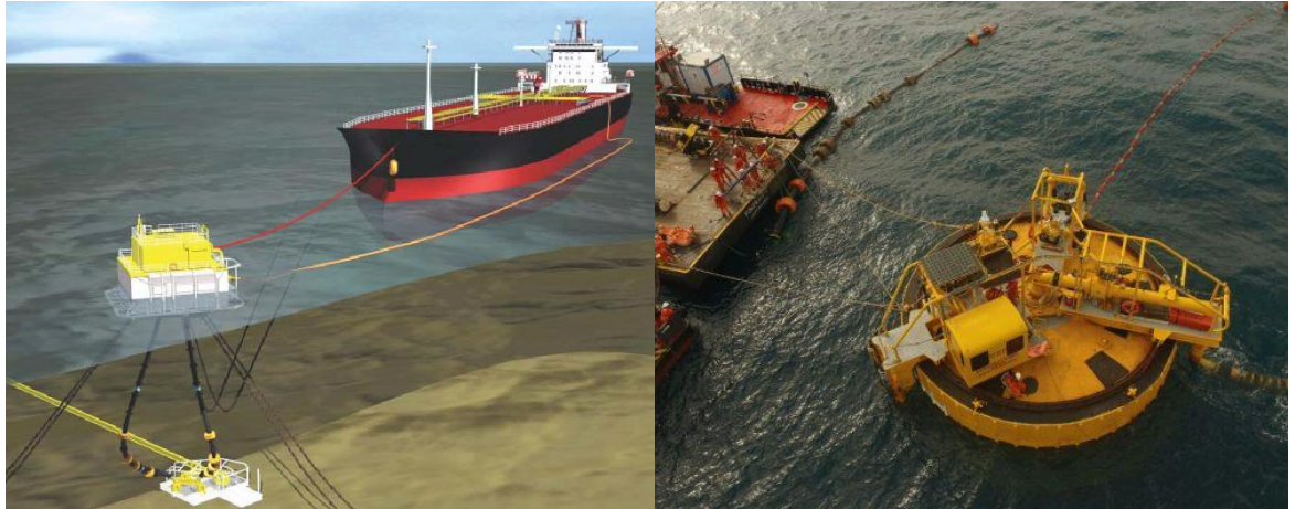
Figura 32. Izquierda: Esquema monoboya. Derecha: Monoboya posicionada mar adentro
