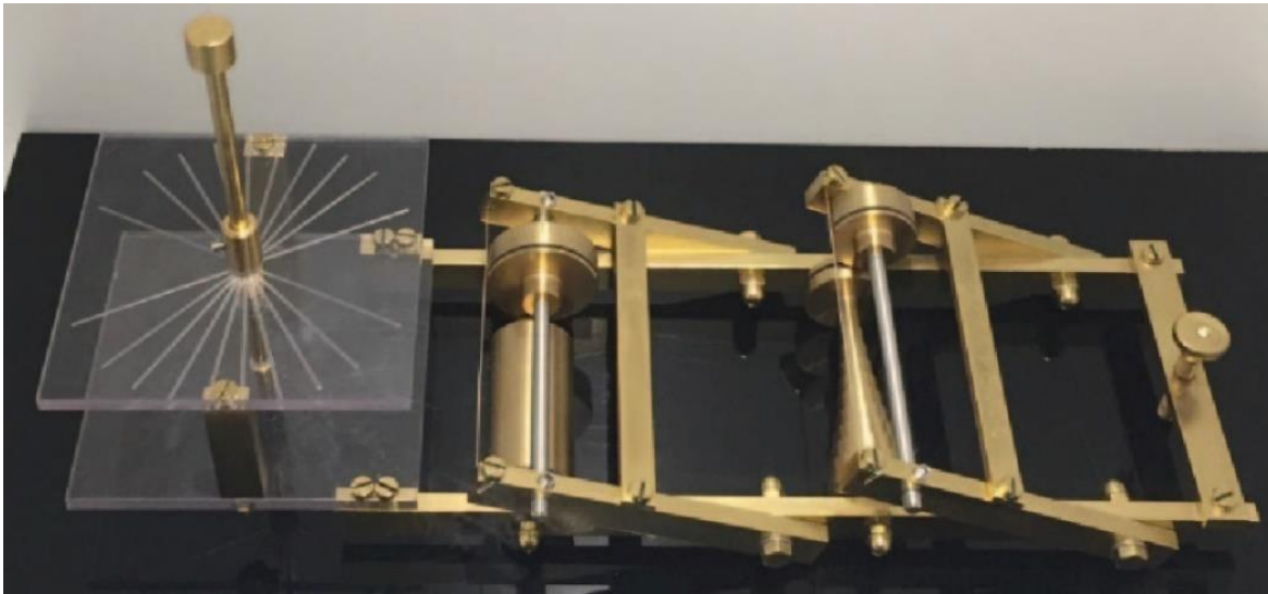
Figura 1 - Dispositivo Análogo Fermiac
