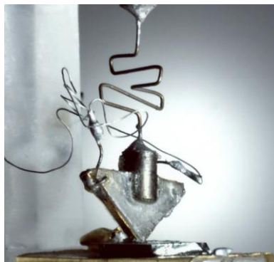
Figura 3 - Primer transistor creado en 1947
