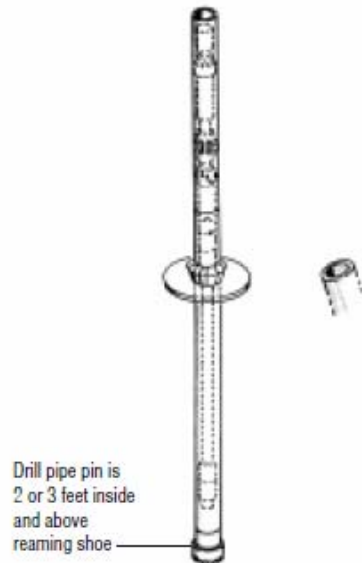
Figura 37. Ensamblaje del Bowen Lebus Anchor Washpipe Spear, Paso 5
