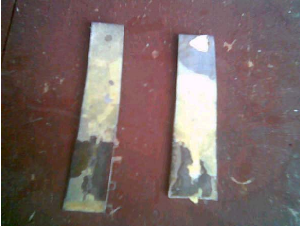
Foto 7. Lámina después de ser sometida al Ataque Químico del Ácido Nítrico
