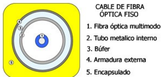
Figura 4-2: Configuración del cable de fibra óptica FISO.
