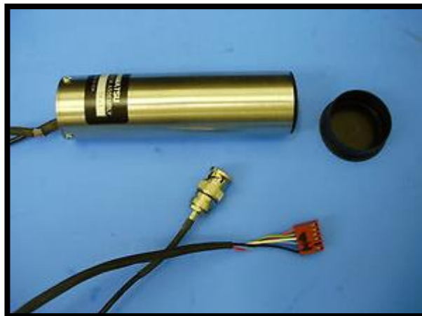
Figura 5 Fotomultiplicador con etapas internas FUENTE: hamamatsu
