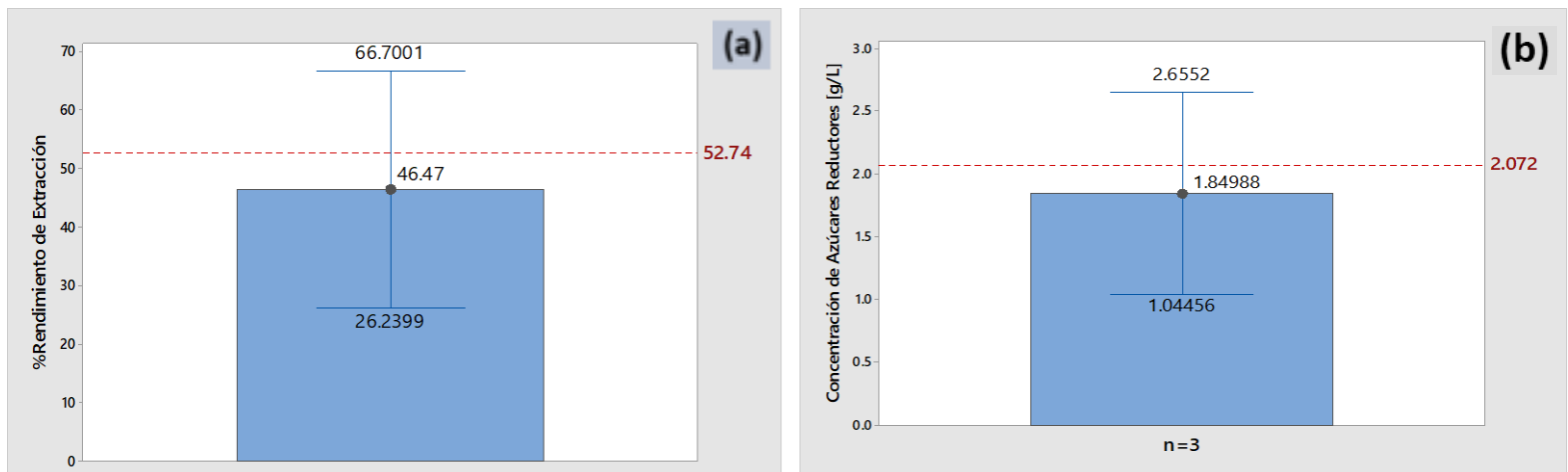
Figura 5. Evaluación del Ajuste de los Modelos de %Rendimiento (a) y Concentración de Azúcares Reductores (b) en el Punto Óptimo para el Nim: pH 8.3, Dp 0.317 mm, L:S 7.48 mL:g.
