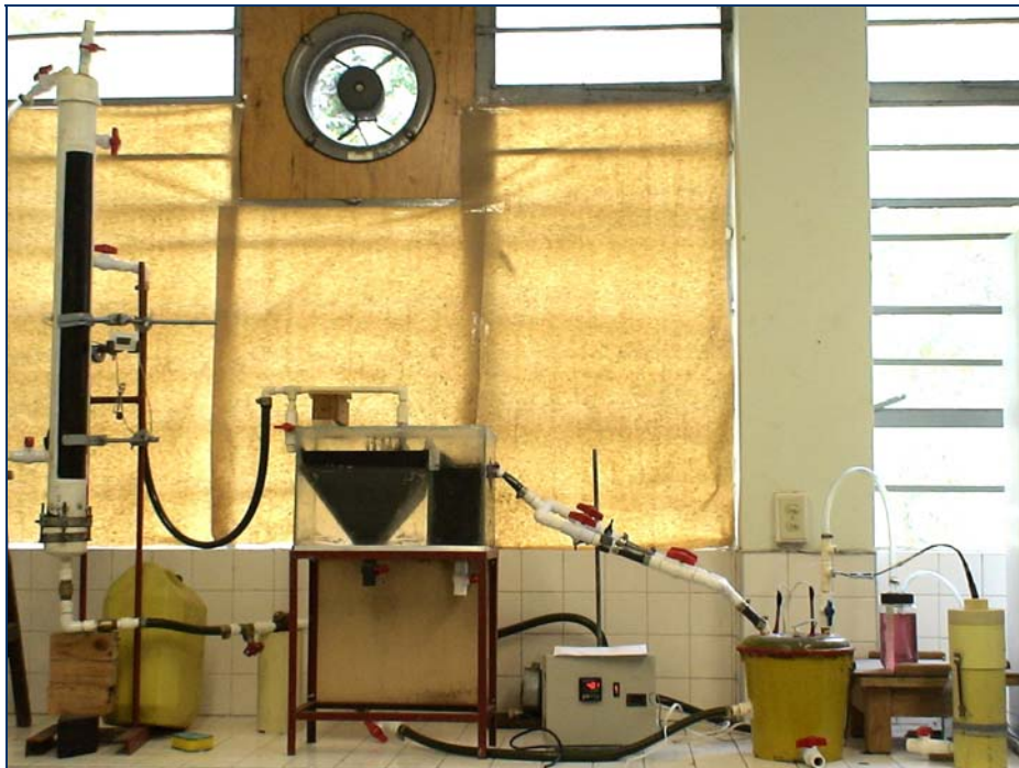
Figura 5. Sistema de Tratamiento Anaerobio de Lecho Expandido para Vinazas – Escala Piloto Laboratorio.
