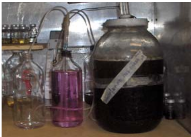
Figura 3. Reactor de aclimatación de inóculo y formación de biopelícula
