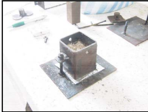
Figura 9. Llenado y compactación de moldes
