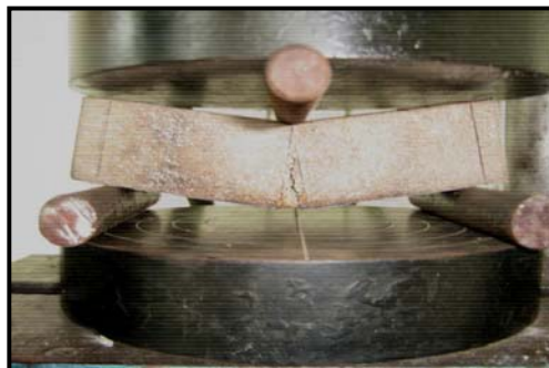
Figura 14. Ensayo de flexión
