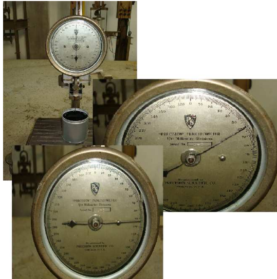
Figura 15. Ensayo de Penetración.
