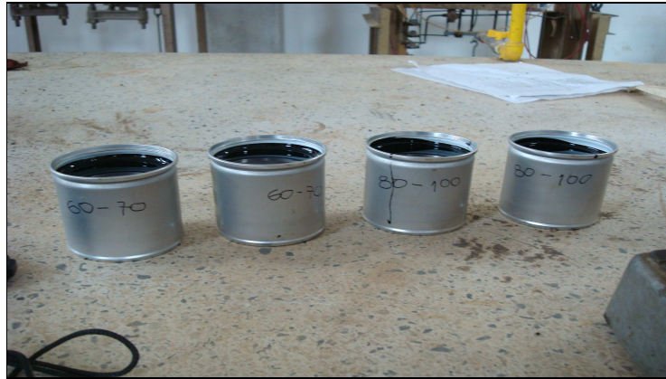
Figura 13. Moldes de Asfalto, Enfriados al aire.
