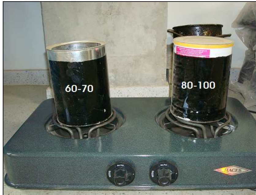
Figura 12. Ensayo de penetración, Calentamiento del Asfalto.
