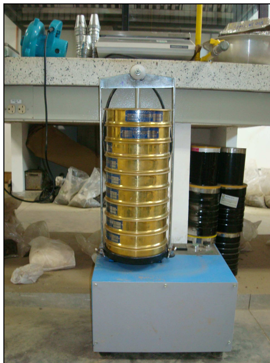
Figura 10. Tamizadora de agregados.
