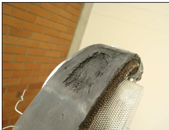
Figura 26. Desgaste del caucho que simula la llanta de camión, luego de la realización de la prueba.
