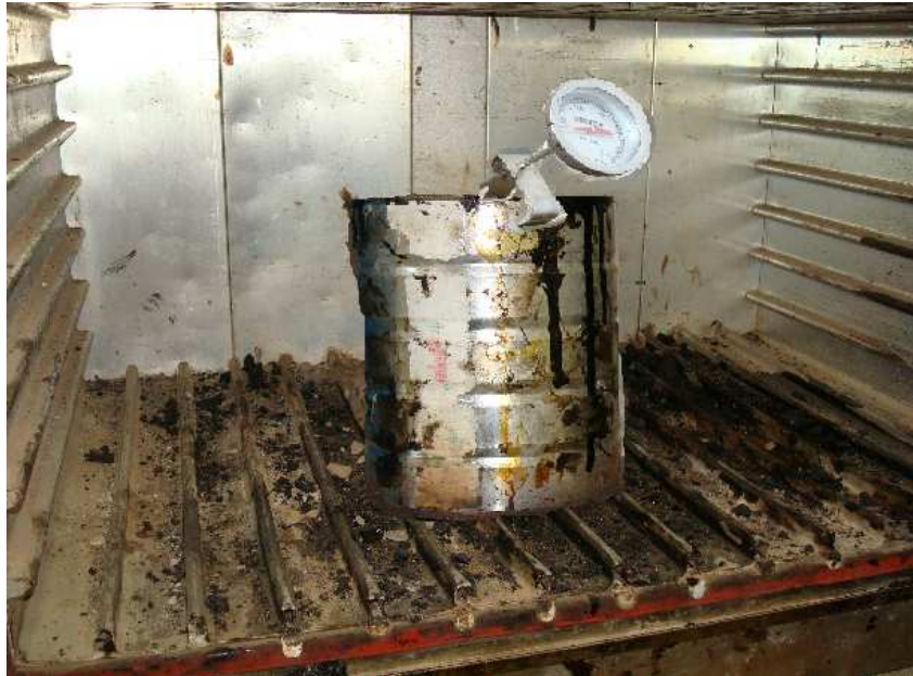
Figura 19. Calentamiento del asfalto en horno.
