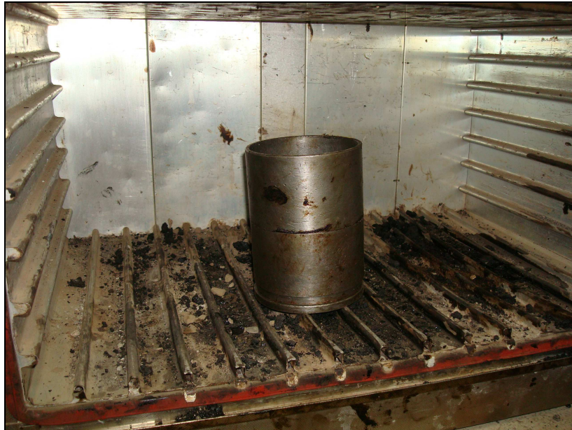
Figura 17. Calentamiento del molde.
