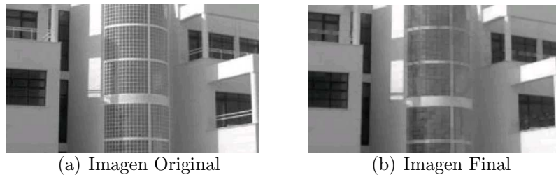
Figura 28: Apertura de una imagen por un elemento estructurante 3 \times 3 . Se observa que los objetos claros son eliminados.
