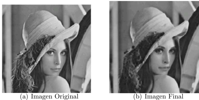
Figura 24: Erosión de una imagen por un elemento estructurante 3x3
