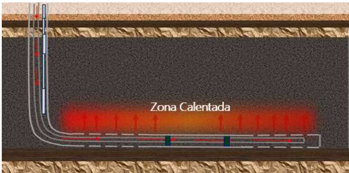
Figura 4. Etapa de precalentamiento del SW-SAGD
