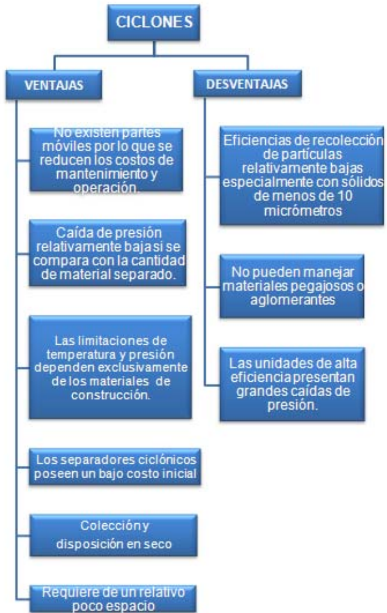
Figura 29. Ventajas y desventajas de los separadores ciclónicos
