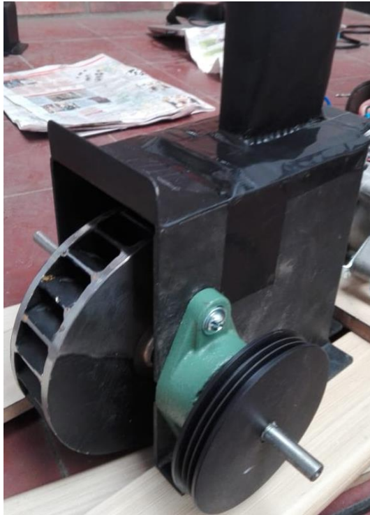
Figura 38. Sistema de la turbina ensamblado.
