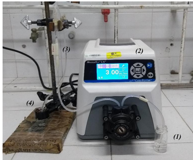
Figura 3. Montaje para ensayos de remoción. (1) Fuente de alimentación con solución de KCl. (2) Sistema de bombeo (bomba peristáltica marca Cole-Parmer ). (3) Columna empacada con el compuesto. (4) Recolección. Laboratorio de investigación en química sostenible, LIQS. UIS. Bucaramanga, 20 de septiembre del 2018.
