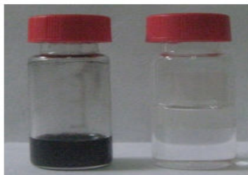
Figura 20. Solubilización de Starbons-300-2-H 2 SO 4 -ClSO 3 H -óxido de trietilfosfina en cloroforno deuterado.
