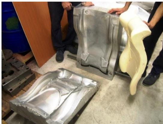
**Figura 63.** Moldes en duraluminio. Obtenido de [http://www.quipplan-tucker.com/wp-content/uploads/2013/07/312\\_moldes-RIM-espumados\\_respaldo.jpg](http://www.quipplan-tucker.com/wp-content/uploads/2013/07/312_moldes-RIM-espumados_respaldo.jpg)
