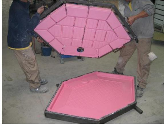
**Figura 64.** Moldes en resina epoxi. Obtenido de <http://decomol.cat/servicios/moldes-para-inyeccion-de-poliuretano-inyeccion-piezas-poliuretano/>
