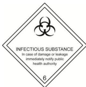
**Figura 2.** Etiqueta de peligro para sustancias infecciosas de categoría A. Obtenido de Guidance on regulations for the Transport of Infectious Substances 2017–2018.
