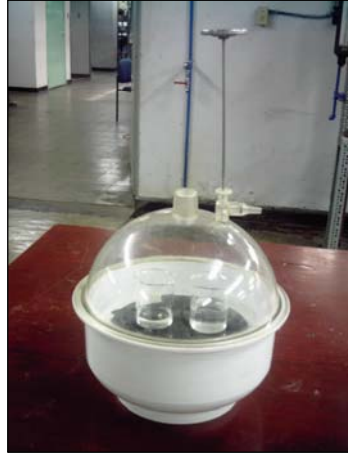
Figura 10. Montaje utilizado para la determinación de CO 2 .
