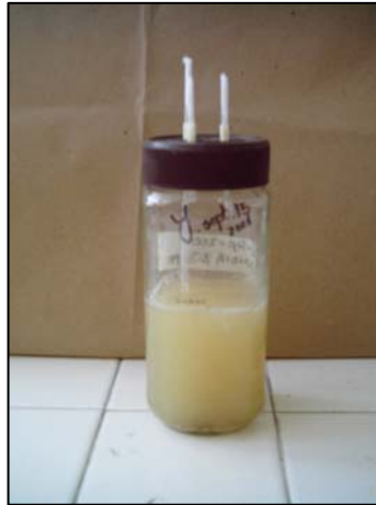
Figura 9. Montaje de microorganismos con muestras de poliuretano
