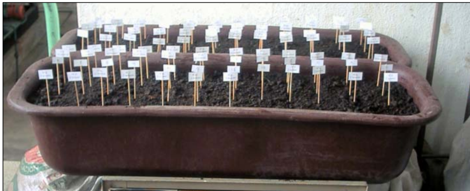
Figura 8. Montaje de muestras enterradas en tierra abonada
