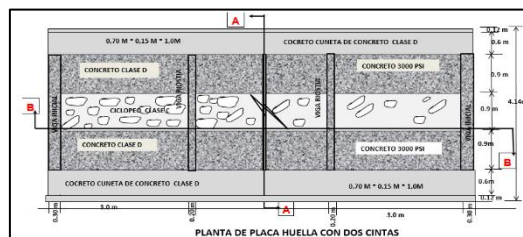
Figura 5. Vista en planta placa huellas
