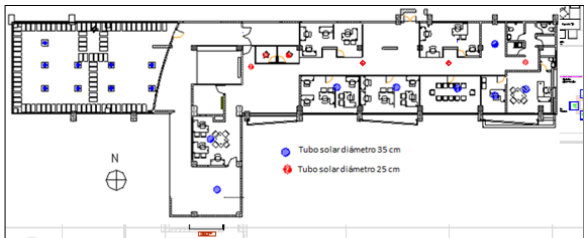
Figura 6. Distribución espacial de los tubos solares en el Edificio de Ingeniería Eléctrica.
