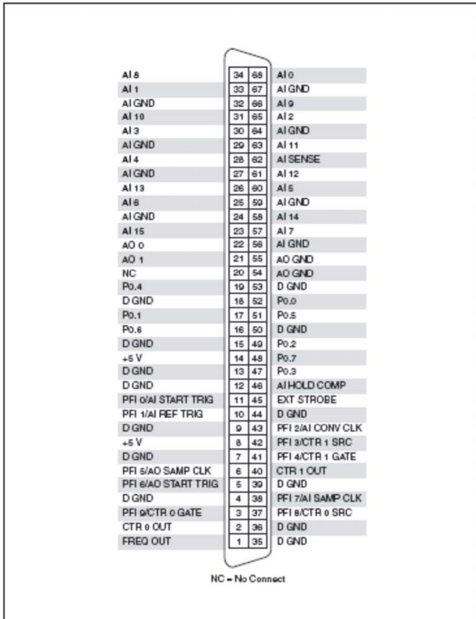
Figure 2. NI 6024E Pinout
